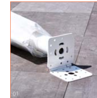
01 — Stabile Verankerung der Masten in der lastabtragenden Unterkonstruktion. Einfache Montage durch eingebundene Klappadapter, die flächenbündig in ausgefräste Bodenplatten eingebettet sind und durch den darunterliegenden Wasserablauf eine flächendeckende Entwässerung gewährleisten. Stable mast anchoring in the load-carrying substructure. Easy assembly due to integrated foldable adapters imbedded flush in countersunk base plates, which ensure comprehensive drainage.
