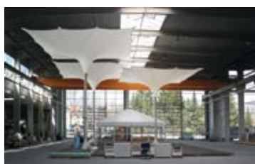
Montagehalle mit 30m Spannweite Final assembly with 30m span
